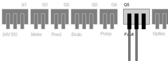
Kontakt im Gutzustand geschlossen, im Fehlerfall geöffnet
