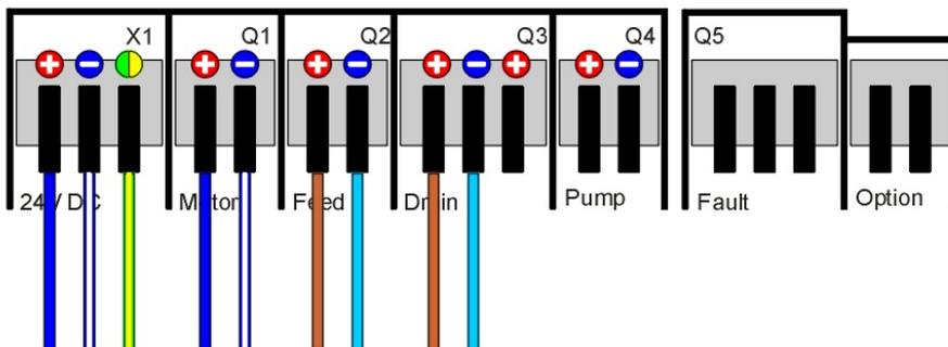
Abbildung 13: Ausgänge verdrahten
