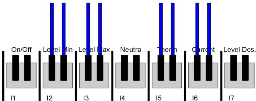
Abbildung 9: Eingänge verdrahten
