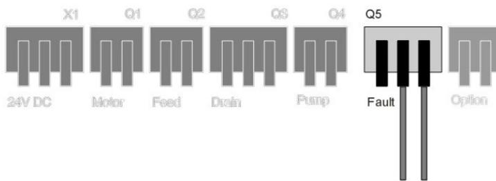
Kontakt im Gutzustand geöffnet, im Fehlerfall geschlossen
