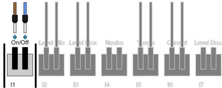
Wird der Eingang durch einen geschlossenen Kontakt aktiviert, wird das Gerät eingeschaltet. Andernfalls wird das Gerät ausgeschaltet. Der Kontakt kann z.B. mit der bauseitigen Lüftungsanlage oder mit dem Frequenzumrichter des Ventilators verbunden werden.
