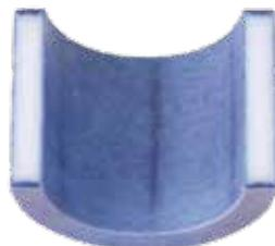
Vergleichsprobe einer 99,7 %  $\text{Al}_2\text{O}_3$ -Keramik bei der das Schnittbild den deutlichen Angriff des Gefüges zeigt.
