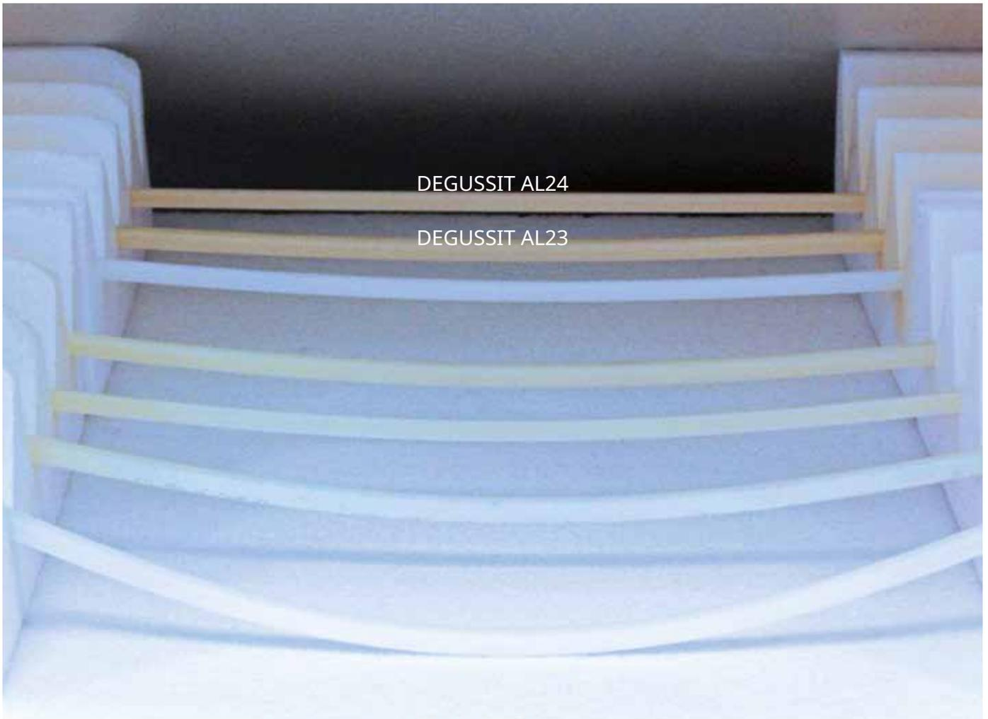
Vergleichstest zur Hochtemperaturfestigkeit von  $AL_2O_3$
