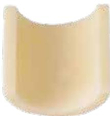
DEGUSSIT AL23 Probe nach dem unten beschriebenen Korrosionstest. Die fehlende Einfärbung durch die Methylenblaulösung zeigt, dass die Schwefelsäure das Gefüge nicht angegriffen hat.
