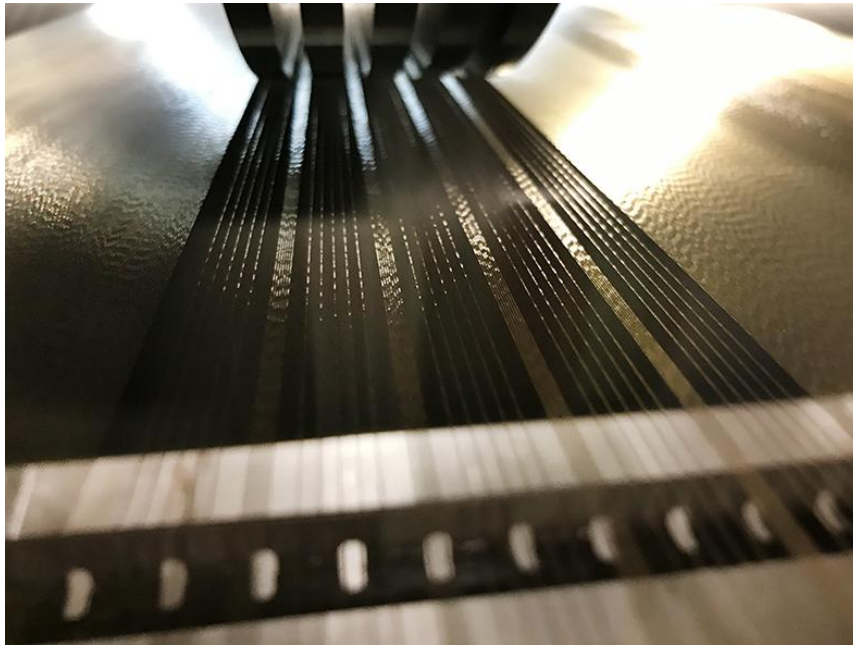
Nahaufnahme einer Anlage zum Vieldrahtsägen
